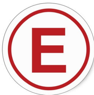
Obrázek 5: Příklad provedení označení ovládání hasicího systému
